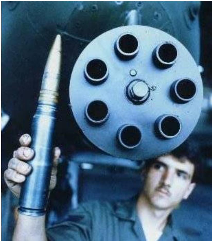
e questo invece è un proiettile calibro 30mm. del cannone GAU-8/A
